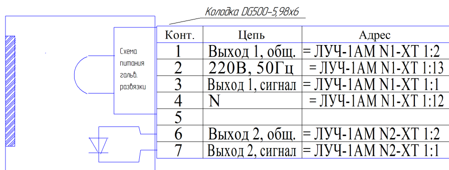
Рис.8. Выходные электрические цепи фотодатчика ФД-05ГМ.
